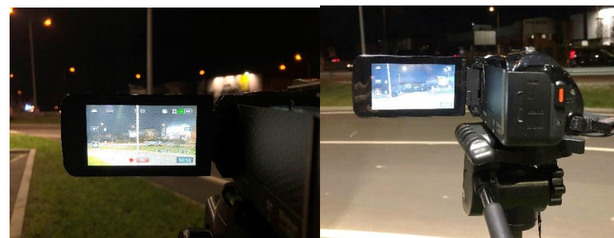
Foto 9 – Postazione di rilievo con telecamera
